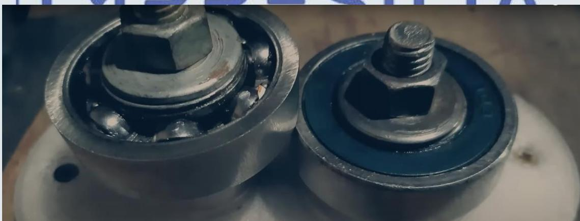
El siguiente paso es cortar: se utilizan dos rodamientos, uno apoyado sobre el otro, formando así una especie de tijera.
